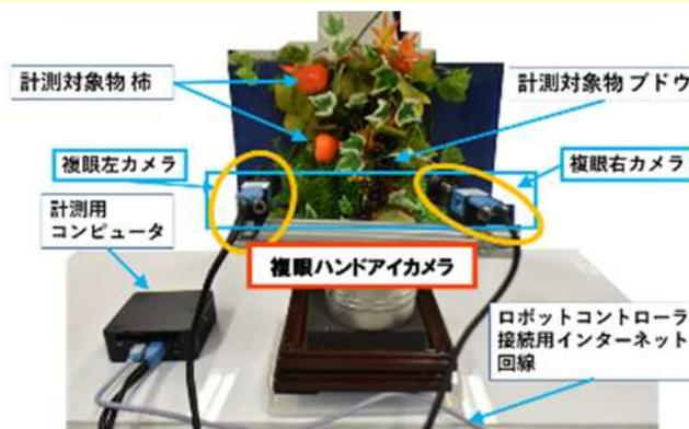
農業用ロボット搭載用の複眼ハンドアイカメラ。カメラ部から対象物（柿）までの位置と柿の寸法測定し、その結果をもとに対象物にハンド部を接近させ、把持・収穫します。計測と接近を繰り返すことで、至近距離からの計測が可能となり高精度なロボット収穫作業が可能です。
