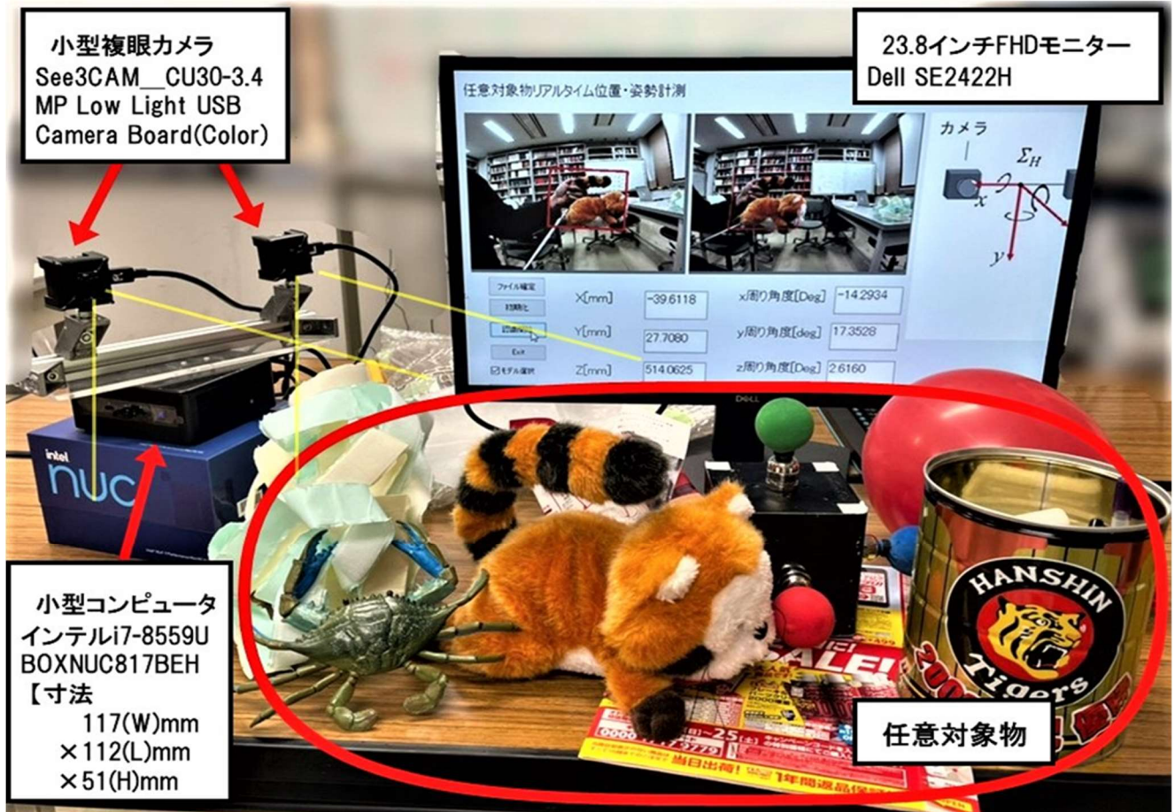
任意対象物位置姿勢計測装置（左：コンピュータ 左上：複眼カメラ 上：モニター）と任意対象物例（からまったテープ、トラのぬいぐるみ、カニ、雑誌など）
